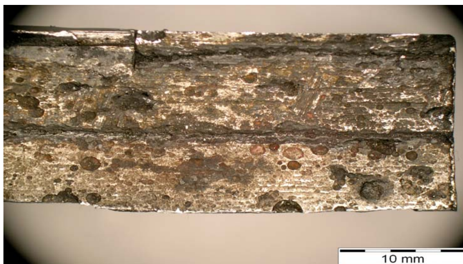
Рисунок 4.1 Вид поверхности темплета с внутренней стороны «кармана».
