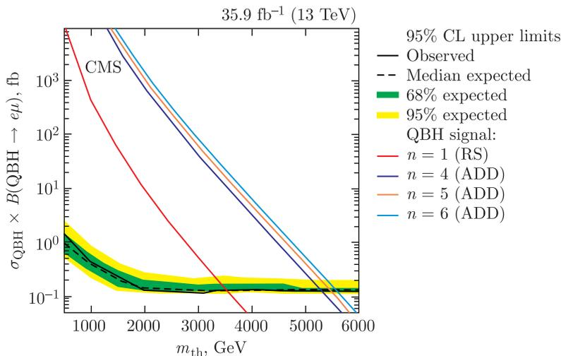
Верхние пределы при 95%-м уровне достоверности для средней величины произведения сечения сигнала и вероятности распада КЧД в  $e\mu$  как функции порогового значения массы  $m_{th}$ . Интервалы уровней достоверности 68 и 95 % для медианы выделены зеленым и желтым цветом соответственно. Показаны предсказания для нескольких моделей с большим числом дополнительных пространственных измерений, в частности, для одного дополнительного измерения (RS) и для  $n = 4$ , 5 и 6 дополнительных измерений (ADD)
