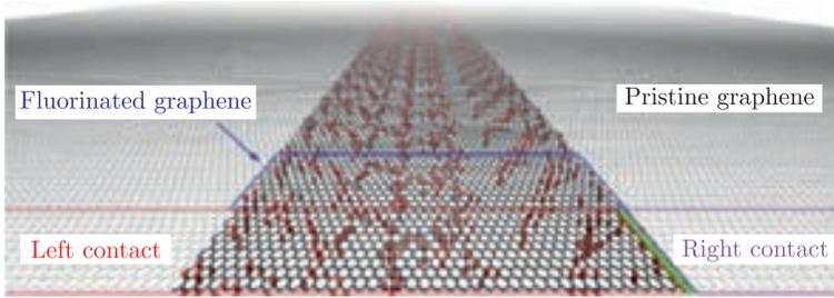
вале значений концентрации атомов фтора, а также при различной степени их упорядочения. Обнаружено соответствие между нерегулярностью расположения атомов фтора и электронными свойствами. Предложенное рассмотрение позволило воспроизвести два экспериментальных наблюдения в данном материале, а именно: электрон-дырочную асимметрию транспортных свойств и пик в проводимости при концентрации фтора около 10%.
