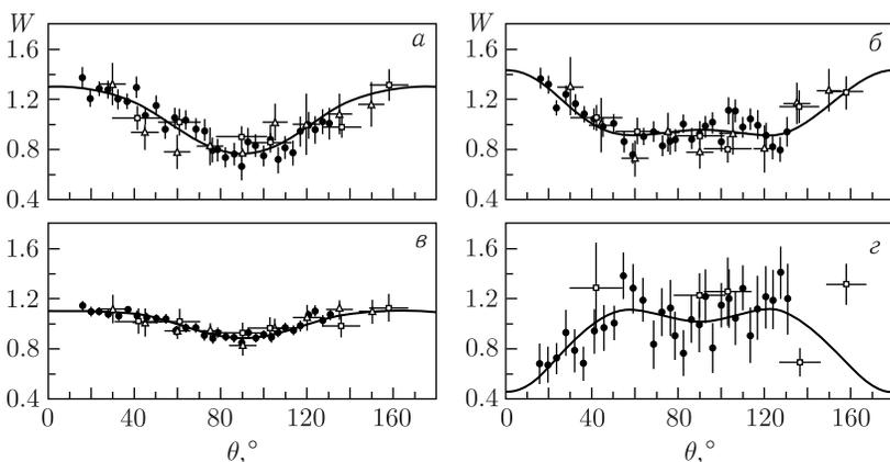
Угловые распределения  $\gamma$ -квантов для переходов в  $^{52}\text{Cr}(n, n'\gamma)^{52}\text{Cr}$   $E_\gamma = 935,5$  кэВ (а), 1333,7 кэВ (б), 1434,1 кэВ (в) и 1530,7 кэВ (г). Сплошные кривые — аппроксимация данных полиномами Лежандра
