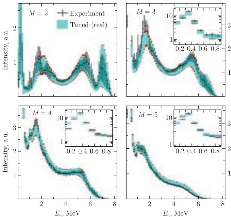
Сравнение экспериментальных данных с моделированием для резонансов со спином  $1^-$ . Черным цветом отмечены экспериментальные данные с флуктуацией по резонансам, голубой пояс — моделирование (среднее значение и стандартное отклонение)
