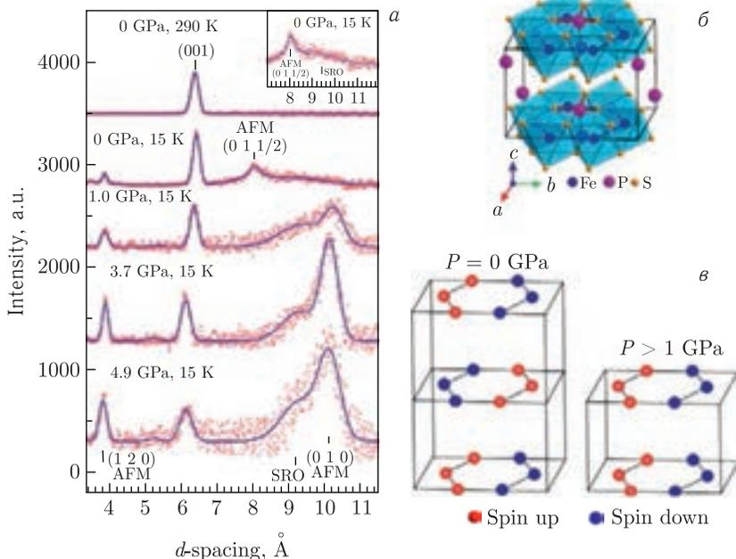
а) Нейтронные дифракционные спектры FePS<sub>3</sub>, измеренные при различных значениях давления и температуры на дифрактометре ДН-12 и обработанные по методу Ритвельда. б) Моноклинная структура FePS<sub>3</sub> симметрии C2/m. в) Магнитная структура FePS<sub>3</sub> при нормальном и высоком давлении
