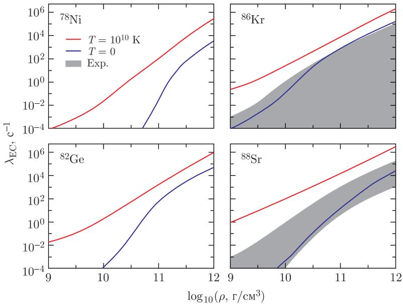
Скорости захвата электронов как функция плотности вещества коллапсирующего кора. Скорости захвата, соответствующие экспериментальной силе ГТ-переходов, представлены с учетом экспериментальных ошибок
